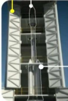
O VLS entrou em processo de ignição antes da hora. Ou seja, o combustível pegou fogo (atingiu primeiro um dos motores e depois se espalhou para os outros três), deixando o foguete pronto para decolar
